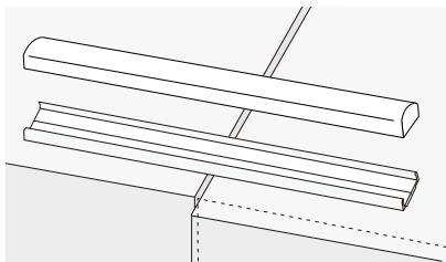
土台の振動やズレをチャンネルが抑制できるので、灯具が断線しにくい。
