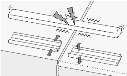
土台の振動やズレが直接灯具に影響し、断線しやすい！
