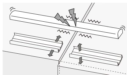
土台の振動やズレが直接灯具に影響し、断線しやすい！
